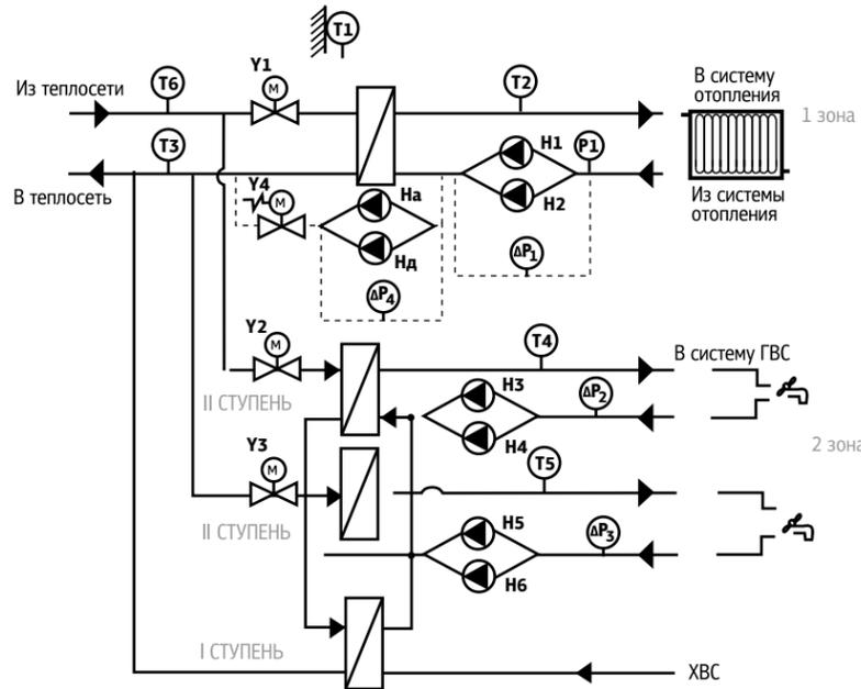
Типовая схема ИТП с двумя контурами отопления (по независимой схеме) и одним контуром ГВС
