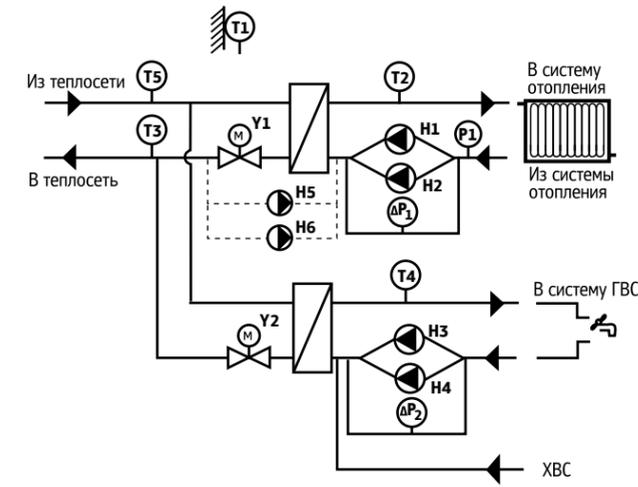
Двухступенчатая система ГВС с теплообменником
